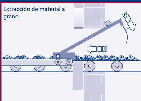
Un rastrillo accionado por energía almacenada, se agita en el proceso de transporte y arrastra el material de transporte.
