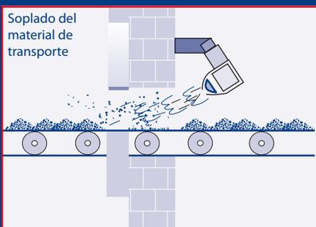
Materiales de transporte ligeros pueden ser sopladados fuera de la zona de cierre mediante el uso de aire comprimido almacenado
