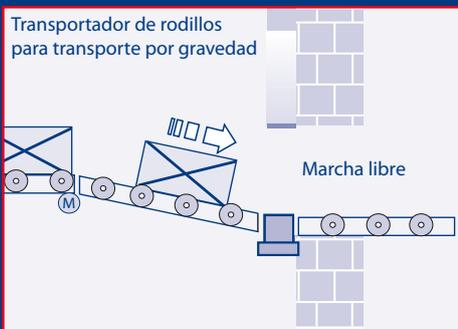
Cuando sistemas de transporte por rodillos con desnivel atraviesan la barrera, se ofrece el cierre con retraso temporal. Condición para eso es que no se formen retenciones del material transportado hasta la zona de cierre.
