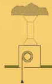
Montáž kastlíku na konzolu, spodní část kastlíku je v rovině s pohledem
