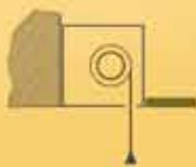
Montáž spodní části kastlíku na stěnu v pohledu
