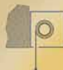
Montáž kastlíku na zeď, podhled se jednostranně napojuje na kastlík, přední chod
