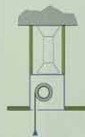
Montáž kastlíku pomocí zavěšení na strop, pohled se oboustranně napojuje na kastlík
